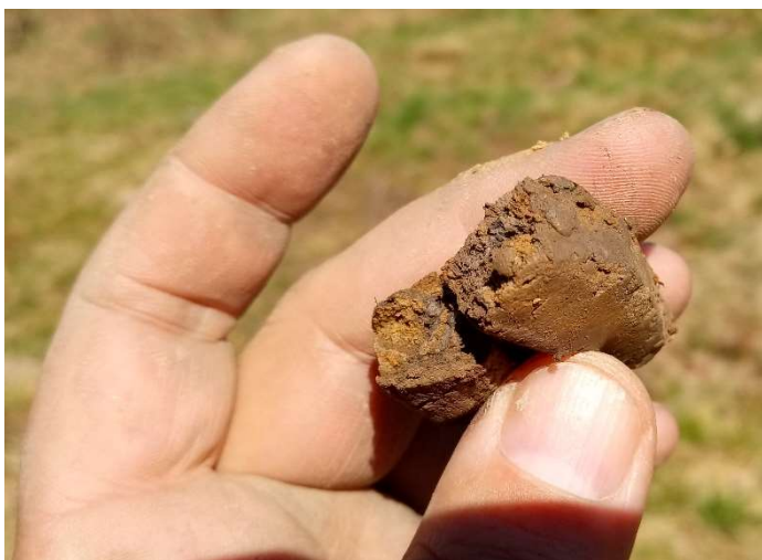
Obr. 6 Charakter hnědých jemně písčitých jílu tuhé/pevné konzistence
